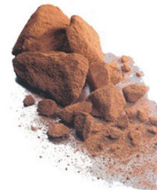
**Figura 2.33.** El aluminio se obtiene del mineral conocido como bauxita. Es el tercer elemento más abundante en la Tierra, solo después del oxígeno y el silicio.
