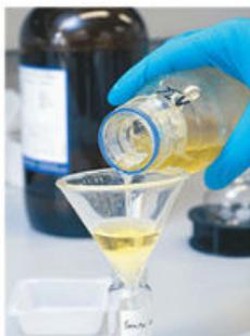
**Figura 4.9.** Antes de desechar sustancias ácidas o básicas, es necesario neutralizarlas con el fin de evitar verter en el ambiente sustancias que lo alteren.
