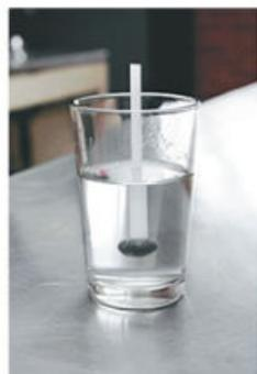
**Figura 1.26.** Este dispositivo es un densímetro rudimentario y basa su funcionamiento en el principio de Arquímedes.
