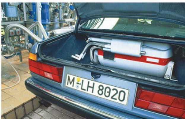
**Figura 1.8.** Vehículos como el de la imagen utilizan hidrógeno como fuente de energía y producen agua en lugar de las emisiones contaminantes de los combustibles tradicionales.
