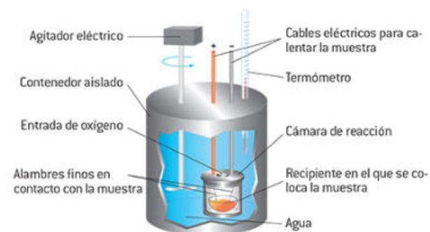
**Figura 3.9.** Dentro del calorímetro, el alimento se quema en presencia de oxígeno y el calor fluye hacia el agua que rodea la cámara de combustión.
