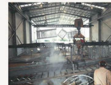
**Figura 4.47.** El galvanizado es un proceso muy común para proteger los materiales de la corrosión.
