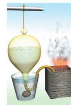
**Figura 1.45.** En la cubeta de Hales el gas se mueve por el tubo y al burbujear dentro del recipiente desplaza el agua que sale por el fondo abierto. Así pueden recolectarse gases insolubles en agua.
