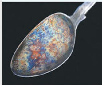
Figura 4.31. La plata tiende a mancharse con el tiempo debido a una reacción redox.
