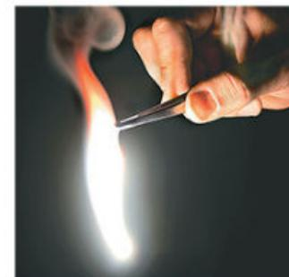
Figura 2.47 El magnesio es un metal alcalinotérreo que al arder produce una luz blanca intensa, por lo que se utiliza en los fuegos artificiales.
