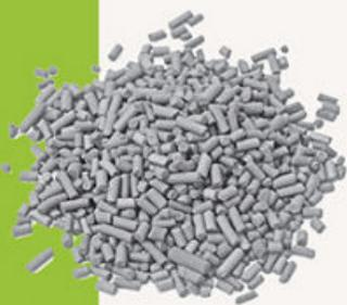
El carbón activado se usa para remover residuos de cloro y materia orgánica, causantes del olor y color en el agua.
